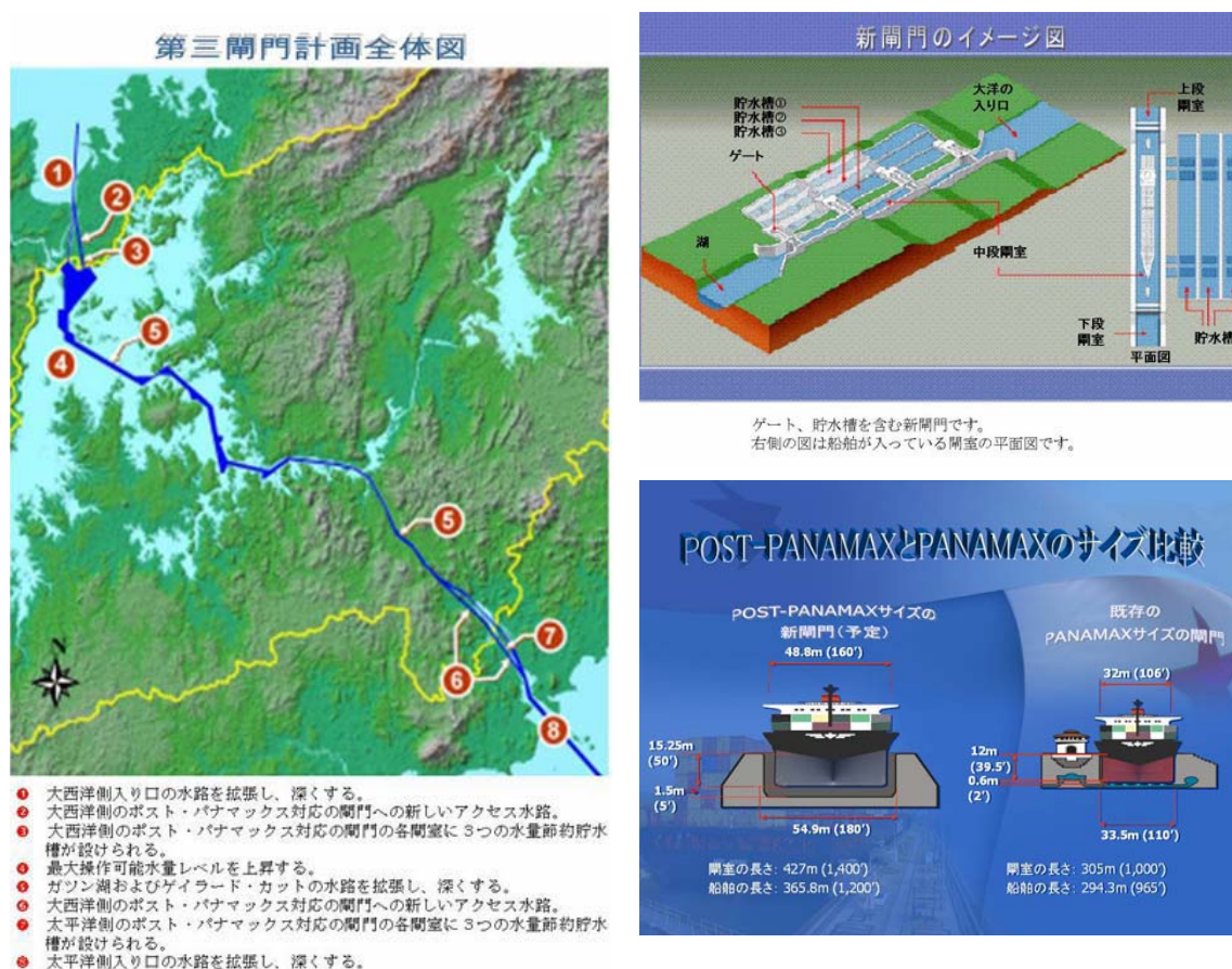
図表 4-1 パナマ運河拡張工事計画全体図及び Post-Panamax と Panamax サイズ比較
