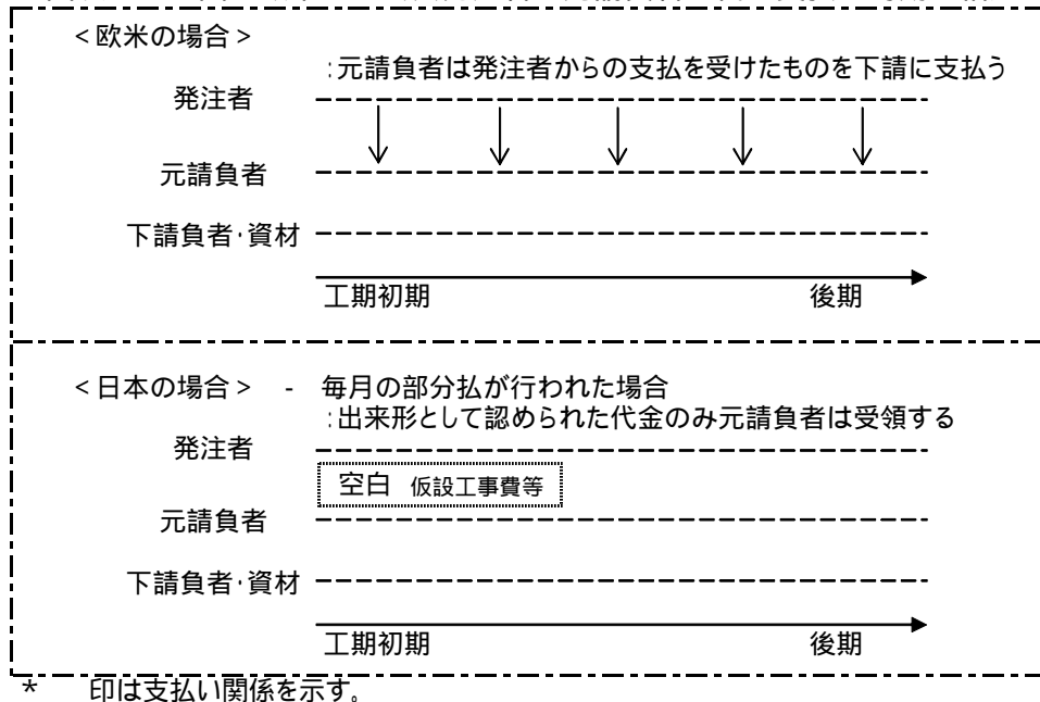
図表 わが国と欧米との公共発注者・元請負者の代金支払の時期の相違
