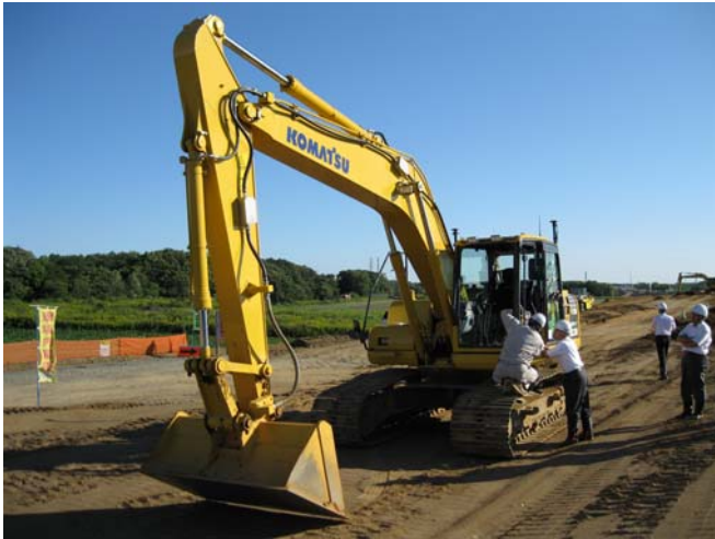
情報化施工対応+Hybrid 仕様の油圧ショベル KOMATSU PC-200(自社機)
