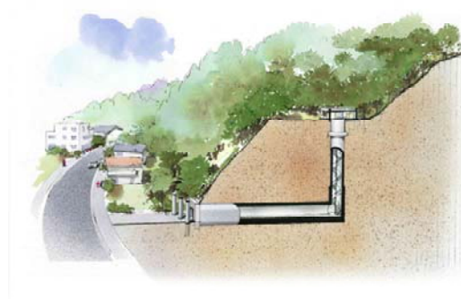
図表4 室戸市の崖地に建設する津波避難シェルターのイメージ
