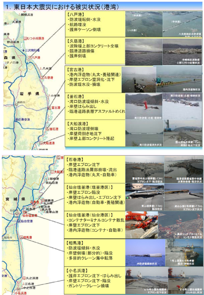
図表 7 東北地方整備局管轄の国際拠点港湾及び重要港湾の被災状況
