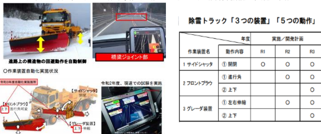
図表 7 除雪トラック作業装置自動化に向けた自動制御機能の実施／開発
