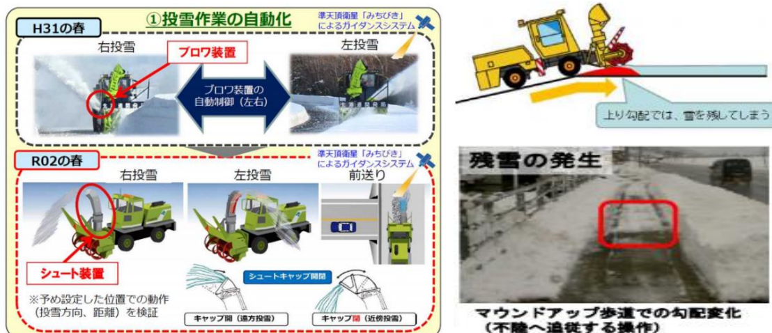
図表 8 歩道除雪車の作業装置の自動化（投雪作業（左）、不陸追従操作（右））
