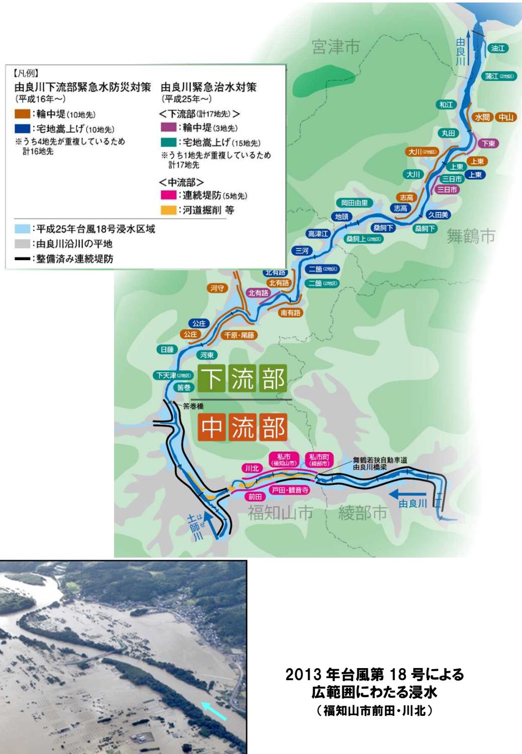
図表 3-2-3 由良川での緊急的な治水対策
