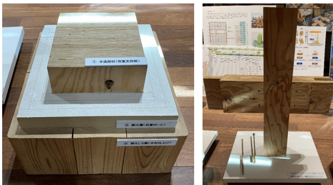
図表29 「オメガウッド（耐火）」（2 時間耐火仕様）と「剛接合仕口ユニット」のサンプル
