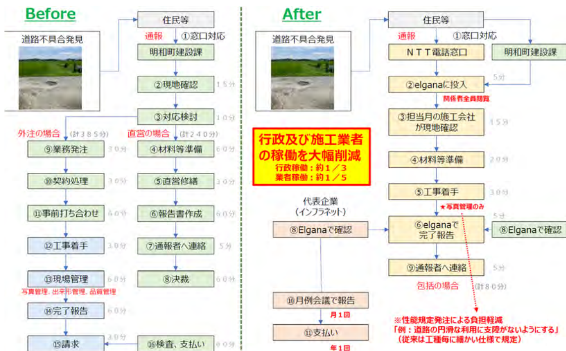
図表14 elgana 導入前後の舗装修繕工事の業務フロー
